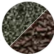
Estado Físico: micro 2 mm - pellet 4 mm
